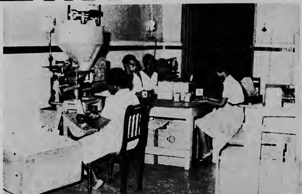
Riba e foto aki, nan ta pak koffie mulá. Por mira na man robes, a machin cu ta plisa e koffie automaticamente.
